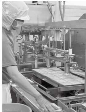
トレーパックに原材料を充填して包装
