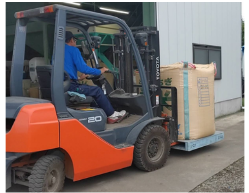
トラックに1tのフレコンバックを フォークリフトを使って運びこみます。 作業がスムーズにいくように 交替で連携を図ります。
