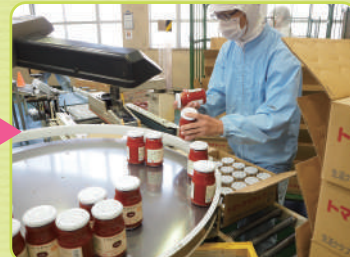
最後は目視で点検。びんにひび割れがないかなど、逆さにするのでフタのうらにケチャップがつきます
