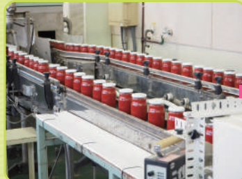
最後は目視で点検。びんにひび割れがないかなど、逆さにするのでフタのうらにケチャップがつきます
