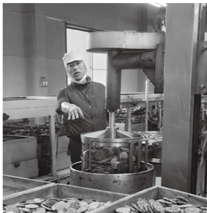
胡麻だくさんせんべい専用の焼機。 長さは13mにもおよび機械の近くは50℃以上になる
