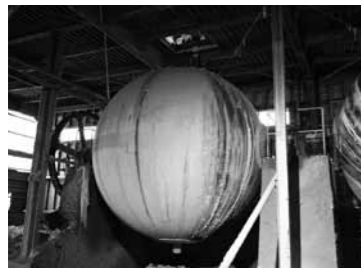
古紙を最初に処理する地球釜。約12トンの古紙と水、最小限の薬品を入れ、4～5時間かけて蒸気でじっくりほぐします。こうして繊維を丁寧に取り出し、ふんわりした紙の原料が生まれます。古紙の選別や釜の操作など、多くの工程は人の手で支えられています。
