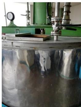
消費材は熱エネルギー排出の少ない上記の「中和法」で製造しています。写真タンクで苛性カリ・精製水・脂肪酸を混ぜて「カリ石けん素地」を作ります。その後、調合タンクでクエン酸、グリセリン、香料など必要なものを添加し、フィルターを通した後、容器に充填され、消費材となります。
